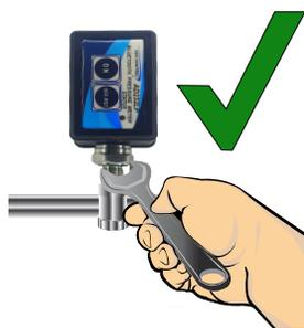
Para asegurar la conexión hermética entre los accesorios y el sistema presurizado según el caso será necesario instalar juntas (o'rings) planas o también arandelas en hilos rectos (BSP). En hilos cónicos (NPT) se debe utilizar material complementario de sellos como por ejemplo cinta de teflón.
