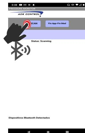
Una vez localizado e identificado el módulo analizador con su respectivo número identificador MAC único, de forma automática la aplicación procede a realizar la vinculación y comunicación con el modulo.
