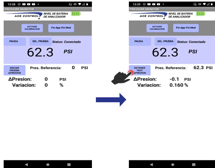
Posteriormente de realizar la finalización de la prueba es posible iniciar nuevamente al oprimir INICIAR PRUEBA Δ PRESIÓN.
