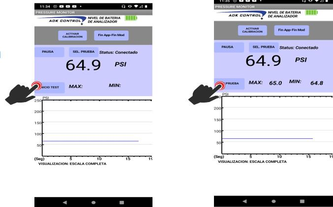
La prueba TEST Max-Min puede ser finalizada en cualquier momento al oprimir el botón FIN PRUEBA.
