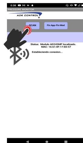
Al llevarse a cabo la conexión entre el módulo manómetro y la aplicación AD360XP observamos la pantalla principal la cual nos indica el Status como Conectado además de mostrar los parámetros iniciales como COMUNICAR, SELECCION DE PRUEBA, CALIBRACION A CERO, Fin App- Fin Mod y cambio de unidades al oprimir el botón Bar o Psi.
