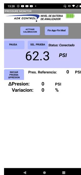
Para iniciar el proceso de prueba de variación de presión solo es necesario oprimir el botón INICIAR PRUEBA Δ PRESIÓN.
