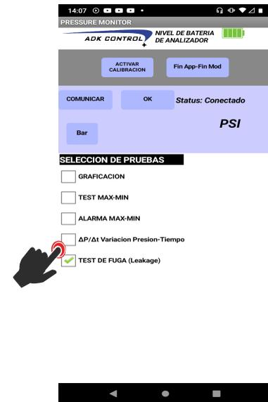
Al iniciar los elementos indicadores de la prueba podremos observar el botón INICIAR TEST DE FUGA y la sección donde se mostrará el proceso de detección de disminución de presión y el respectivo valor calculado en tiempo real además del conteo en segundos hasta alcanzar los 60 segundos transcurridos, tiempo en el cual se mostrará el resultado final de la pérdida de presión ya sea en PSI o Bar y su respectivo valor de pérdida en porcentaje.
