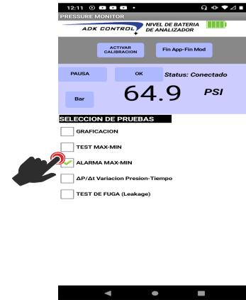
Ahora se despliegan los indicadores de presiones máximas y mínimas, además de las casillas de configuración de alarma de máximos y mínimos.
