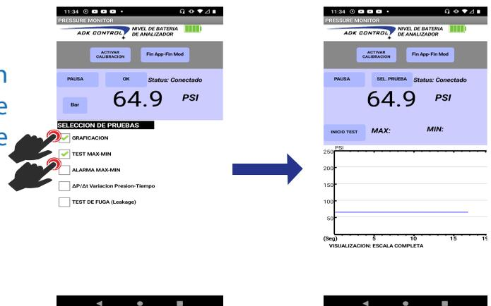
Ejemplo de prueba TEST Max-Min en conjunto con graficación
