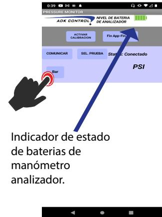
Indicador de estado de baterías de manómetro analizador.
