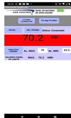
En esta sección observamos un valor mínimo detectado inferior al valor mínimo configurado y como consecuencia quedará registrado en la sección MIN:
