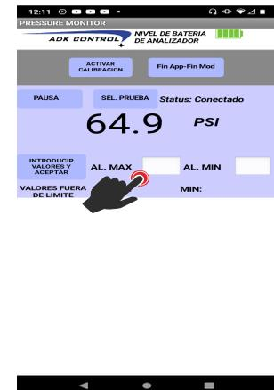
En las casillas de configuración de alerta se introducen los valores que por medio de comparación, al detectar un valor por encima del valor máximo o un valor detectado por debajo del valor mínimo, la aplicación emitirá un estado de alerta el cual consiste en una emisión de sonido de alerta y una vibración a través del smartphone.
