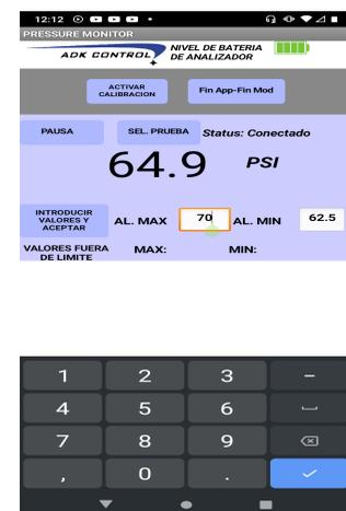
Una vez finalizada la introducción de los datos de valores máximos y mínimos estaremos en posibilidad de iniciar la prueba seleccionando el botón INICIAR TEST, el cual al activarse inicia el monitoreo y registro automático de los valores de presión.
