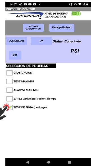
Al iniciar los elementos indicadores de la prueba podremos observar el botón INICIAR TEST DE FUGA y la sección donde se mostrará el proceso de detección de disminución de presión y el respectivo valor calculado en tiempo real además del conteo en segundos hasta alcanzar los 60 segundos transcurridos, tiempo en el cual se mostrará el resultado final de la pérdida de presión ya sea en PSI o Bar y su respectivo valor de pérdida en porcentaje.
