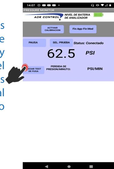
Se observa el inicio de la prueba obteniendo el valor instantáneo de presión el cual toma como referencia para calcular la disminución por minuto y el valor en porcentaje
