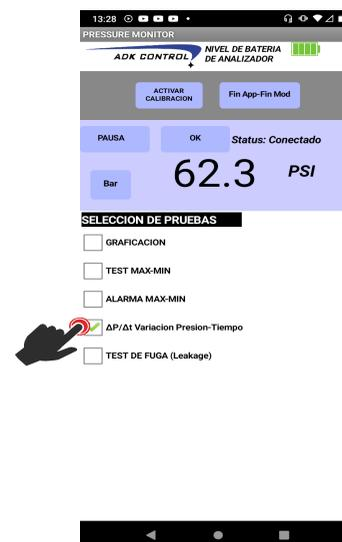
Esta prueba es útil para determinar el porcentaje de variación de presión en tiempo real considerando una presión de referencia que se obtiene en el instante al iniciar la prueba.
