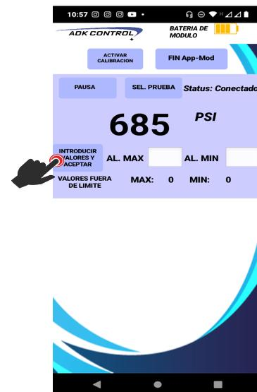
En las casillas de configuración de alerta se introducen los valores que por medio de comparación, al detectar un valor por encima del valor máximo o un valor detectado por debajo del valor mínimo, la aplicación emitirá un estado de alerta el cual consiste en una emisión de sonido de alerta y una vibración a través del smartphone.
