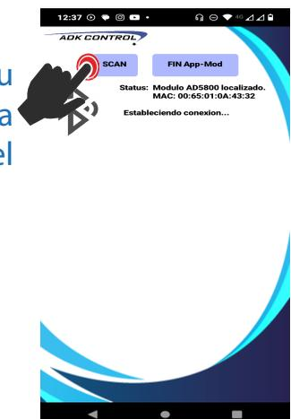
Al llevarse a cabo la conexión entre el módulo manómetro y la aplicación AD5800XP observamos la pantalla principal la cual nos indica el Status como Conectado además de mostrar los parámetros iniciales como COMUNICAR, SELECCION DE PRUEBA, CALIBRACION A CERO, Fin App- Fin Mod y cambio de unidades al oprimir el botón Bar o Psi.
