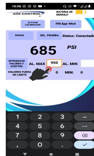
Una vez finalizada la introducción de los datos de valores máximos y mínimos estaremos en posibilidad de iniciar la prueba seleccionando el botón INICIAR TEST, el cual al activarse inicia el monitoreo y registro automático de los valores de presión.
