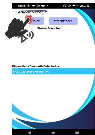
Una vez localizado e identificado el módulo analizador con su respectivo número identificador MAC único, de forma automática la aplicación procede a realizar la vinculación y comunicación con el módulo.
