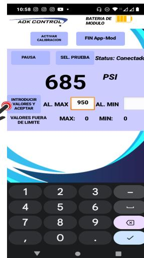
En la imagen del lado derecho observamos un valor superior al valor máximo establecido como alarma y por consecuencia observamos un cambio de color en el fondo del indicador del presión y que va acompañada esta señalización de un sonido de alarma y una vibración en el smartphone.
