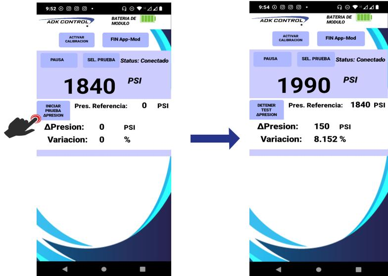
Posteriormente de realizar la detención de la prueba es posible iniciar nuevamente al oprimir INICIAR PRUEBA ΔPRESIÓN.
