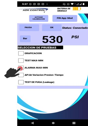
Ahora se despliegan los indicadores de presiones máximas y mínimas, además de las casillas de configuración de alarma de máximos y mínimos.
