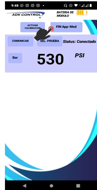
Otra forma correcta de apagado del módulo manómetro es de igual manera en estado de Pausa entre el módulo y la aplicación es oprimiendo el botón OFF/RST del módulo manómetro por lo que el módulo procederá al apagado finalizando la comunicación con la aplicación.
