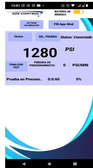
El test tiene un indicador de PRUEBA EN PROCESO y también se indica el progreso del tiempo de la prueba.
