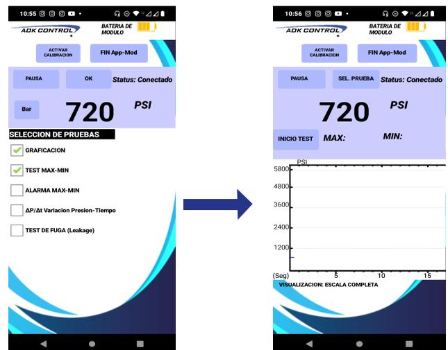
Ejemplo de prueba TEST Max-Min en conjunto con graficación
