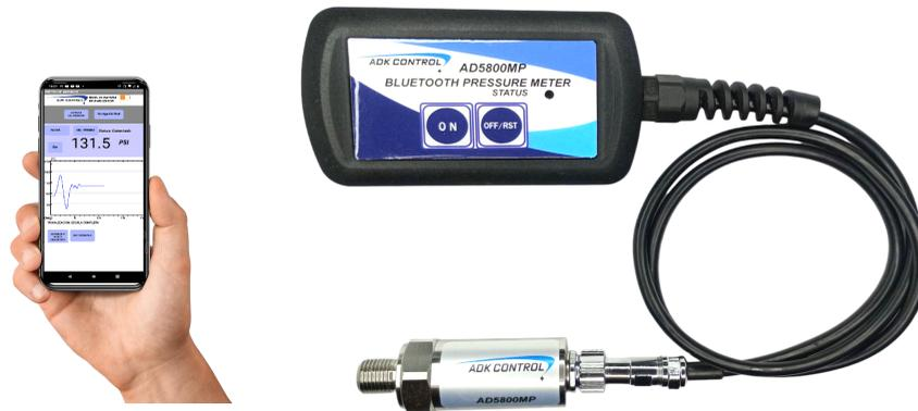
Los Analizadores de presión AD5800MP es un dispositivo manómetro y analizador de presión con comunicación bluetooth el cual a través de la aplicación android AD5800XP se obtiene información de valores de presión y la variación de ésta en el tiempo, además de la visualización de la presión por medio de una interfaz gráfica en tiempo real y distintos modos de prueba.
