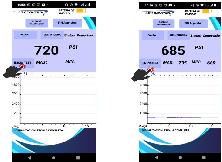
La prueba TEST Max-Min puede ser finalizada en cualquier momento al seleccionar u oprimir el botón FIN PRUEBA.
