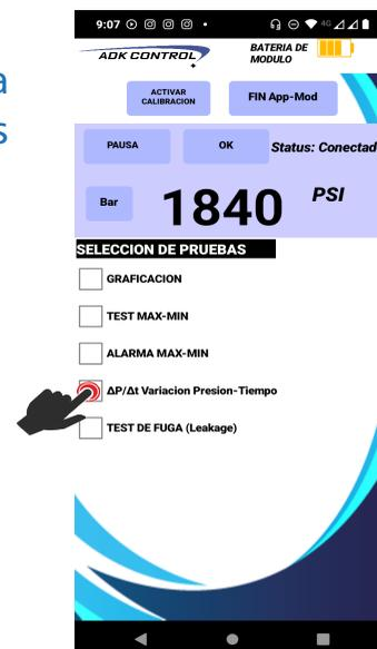
Esta prueba es útil para determinar el porcentaje de variación de presión en tiempo real considerando una presión de referencia que se obtiene en el instante al iniciar la prueba.
