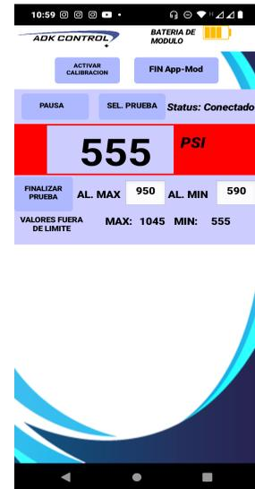
Al finalizar la prueba en el tiempo estipulado por el operador, es posible observar los valores de alerta máximos y mínimos detectados y almacenados en las casillas correspondientes, ahora se procede a seleccionar FINALIZAR PRUEBA.
