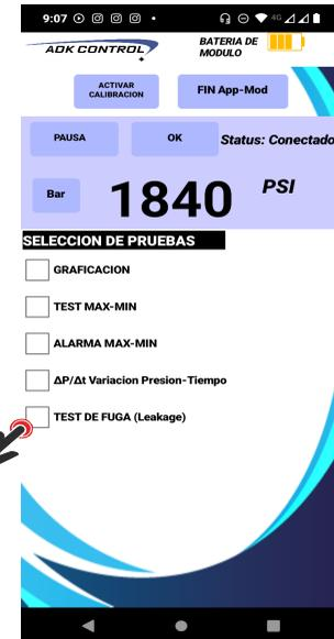
Al iniciar los elementos indicadores de la prueba podremos observar el botón INICIAR TEST DE FUGA y la sección donde se mostrará el proceso de detección de disminución de presión y el respectivo valor calculado en tiempo real además del conteo en segundos hasta alcanzar los 60 segundos transcurridos, tiempo en el cual se mostrará el resultado final de la pérdida de presión ya sea en PSI o Bar y su respectivo valor de pérdida en porcentaje.
