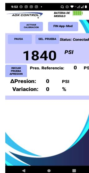
Para iniciar el proceso de prueba de variación de presión solo es necesario oprimir el botón INICIAR PRUEBA ΔPRESIÓN.
