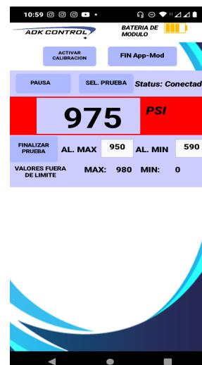
En esta sección observamos un valor mínimo detectado inferior al valor mínimo configurado y como consecuencia quedará registrado en la sección MIN:
