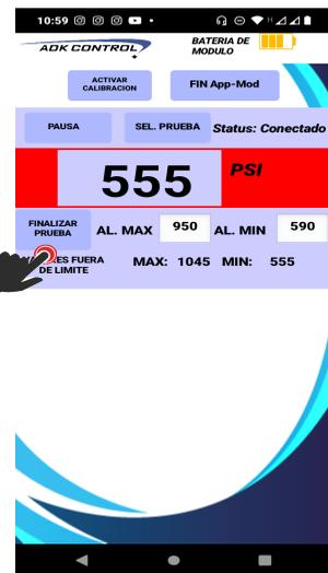
Al seleccionar FINALIZAR PRUEBA los datos registrados son borrados para una prueba subsecuente si así se desea.
